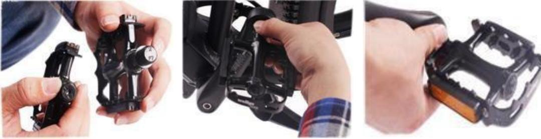
Chaque pédale possède un autocollant « L » ou « R » pour indiquer le côté gauche ou droit du TESLICA Spirit eTrike T1S. Sinon, veuillez vérifier le bord extérieur du corps de la pédale ou l'intérieur de l'axe de la pédale, là où la pédale s'insère dans le bras de la manivelle, pour voir s'il y a un « L » ou un « R » imprimé.
