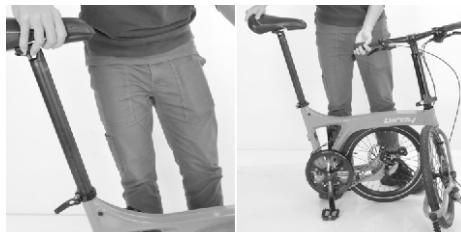
Step 3. 手抓住座墊提起車子，後叉將向後方懸擺，並確定後懸臂扣件已扣緊
