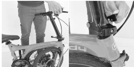
Step 2. 打開座桿快拆，將座桿拉伸至適當高度(可參考座桿上的高度標示)，注意勿拉伸超過安全線，關閉座趕快拆，並轉動車手讓前輪與車身呈90度
