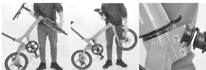
Step 5. 檢查剎車線與變速線是否纏繞、鍊條是否脫落，並再次檢查所有快拆是否扣緊
