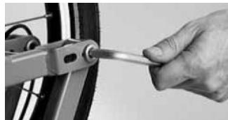
Birdy前叉是由無須保養的IGUS培林所連結的。藉由使用8mm內六角扳手由外側可調整轉軸螺絲的鬆緊。轉軸內側螺絲功用是負責前叉穩妥轉動，不可移除。
