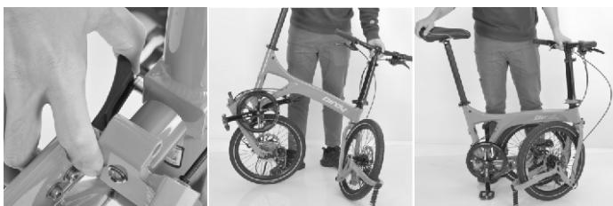
**Step 3. 開啓座桿束快拆，將座桿下壓到底後關閉快拆**
