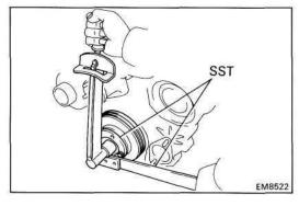
(d) Using SST, install and torque the plate and bolt.
