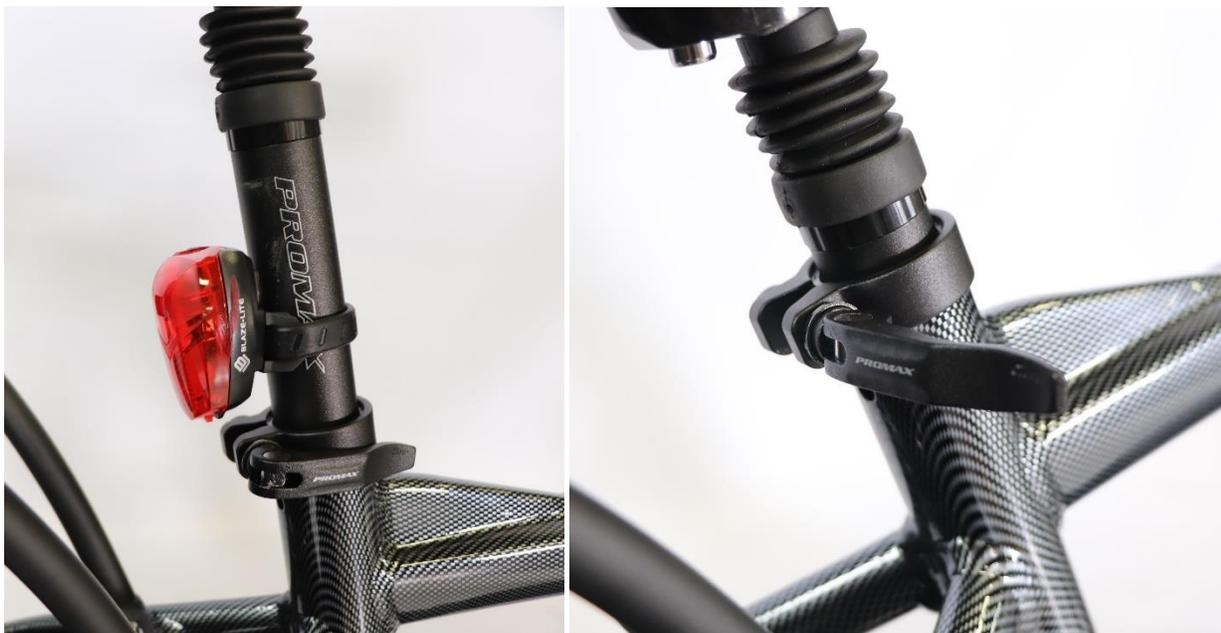
La tige est insérée dans le cadre et réglée à la hauteur désirée. Puis la pince doit être fermée pour verrouiller le siège en position.
