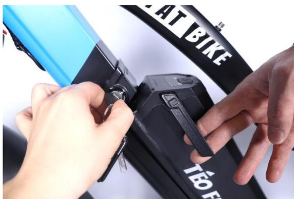
Pour installer la batterie sur le cadre, insérez-la de la même façon qu'elle a été enlevée. Il peut être nécessaire d'utiliser la clé pour installer la batterie. La base de la batterie doit être insérée en premier et poussée dans le cadre du vélo.
