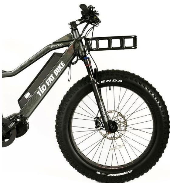
Il est important de noter que le panier est fixé au cadre et non au guidon, le panier ne suivra donc pas la direction du guidon, il reste dans la position fixe.
