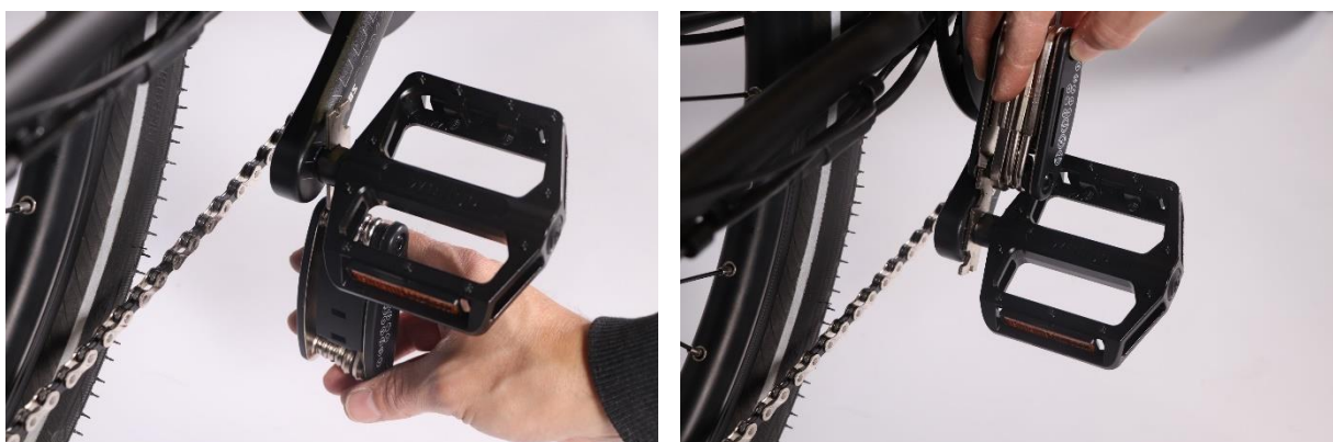
Vissez les pédales comme décrit ci-dessus à l'aide de l'outil montré (inclus dans votre ensemble d'outil).
