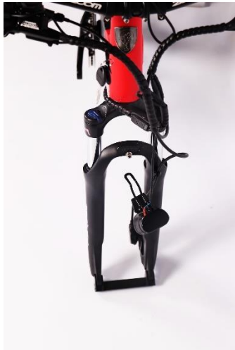
Protecteur de plastique en place
