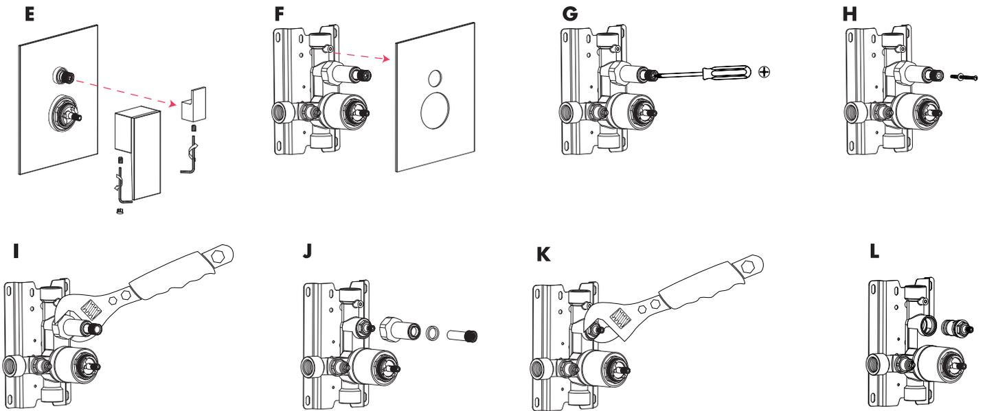
To replace the check valve or the shut-off valve • Pour remplacer la soupape anti-retour ou la soupape d'arrêt
