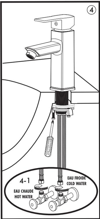
**4.** Vissez le contre-écrou manuellement et, à l'aide d'un tournevis, serrez les vis fermement. Raccordez maintenant les boyaux d'alimentation en acier inoxydable tressé à vos valves d'alimentation (non incluses). Voir figure 4-1. Serrez manuellement et serrez d'un quart de tour supplémentaire à l'aide d'une clé appropriée. Assurez-vous de ne pas endommager les raccords tressés.
