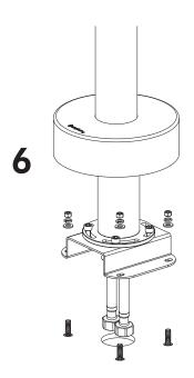
Screw or anchoring the base flange firmly on the floor Visser ou ancrer fermement la bride de la base au plancher
