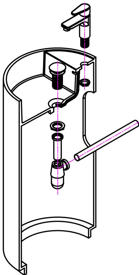
Vérifier l'endroit où le lavabo sera installé. Installez les tuyaux d'arrivée d'eau. Mettez les écrous et rondelles sur les tuyaux, faites-les passer par le trou du robinet de bas en haut.
