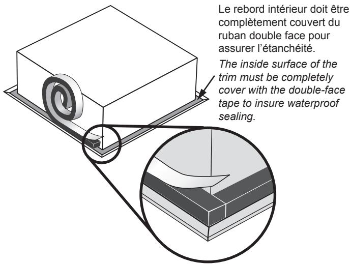
Le rebord intérieur doit être complètement couvert du ruban double face pour assurer l'étanchéité.
