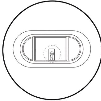
2. Un drain est déjà installé sur le bain. Il est possible de le changer pour un drain d'une autre finition (autres finitions disponibles en options). Si vous ne changez pas le drain passer à l'étape 4.
