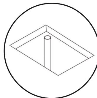
4. Avant de percer un trou dans le plancher pour le tuyau d'évacuation, assurez-vous qu'il n'y a aucun élément en dessous (tuyaux, joints de plancher, conduits de chauffage, fils électrique).
