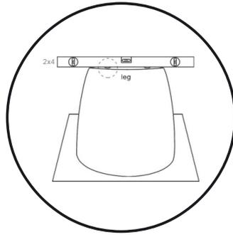
5. Placer le bain à l'envers sur une surface lisse et propre pour protéger la surface. Ajuster les pattes de sorte qu'elles dépassent de 1/8 de pouce de la base du bain.
