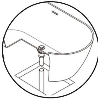
9. Positionner soigneusement la baignoire et connecter le drain à la plomberie (précédemment installé). Terminer l'installation de la pièce de montage.
