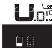
Lors de la recharge des deux accus d'un vélo à deux accus, l'état d'avancement de la charge s'affiche sur l'écran (sur la figure, l'accu de gauche est en train d'être chargé). L'affichage clignotant vous indique lequel des deux accus est en train d'être chargé.
