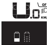
Si en una eBike provista de dos baterías se cargan ambas en la bicicleta, en la pantalla aparecerá el progreso de carga de las dos baterías (en la ilustración se está cargando la batería izquierda). Puede saber cuál de las dos se está cargando en cada momento observando el indicador intermitente de las baterías.
