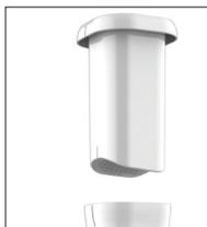
**NOTE :** Le poussoir est asymétrique et doit être inséré d'une seule façon à l'intérieur du tube d'alimentation pour ne pas créer de résistance avec le boîtier. Pour ce faire, insérer le poussoir dans le tube en prenant soin d'aligner la ligne gravée sur le pourtour du poussoir avec celle gravée sur le haut du boîtier. Un poussoir inséré dans le mauvais sens créera une résistance et il sera difficile de pousser adéquatement l'aliment au fond du tube d'alimentation.
