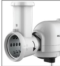
Débrancher l'appareil. Appuyer sur le bouton de déverrouillage noir sur l'appareil pour déverrouiller l'accessoire du batteur sur socle. Tourner l'accessoire dans le sens horaire et le tirer vers l'avant pour le retirer.
