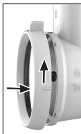
Placer l'anneau de verrouillage sur le boîtier principal en alignant la ligne gravée sur l'anneau avec l'icône
