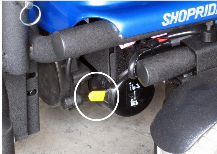
Pour passer en mode « roue libre », localisez les leviers jaunes. Les deux leviers sont équipés d'embouts couverts d'un capuchon jaune et sont abaissés pour désenclencher les moteur/mécanismes et permettre « la roue libre ». Pour réenclencher les moteurs/freins, soulevez les deux leviers jusqu'à ce qu'ils s'enclenchent.
